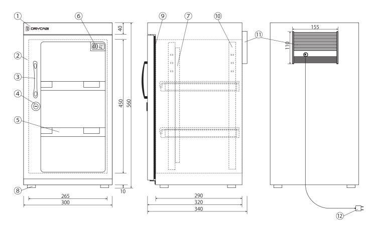
外寸:W300mm×D340mm×H560mm 内寸:W298mm×D290mm×H505mm ※棚板有効寸法W230×D235×H30mm
